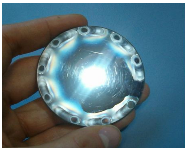
Abb. 32: Germaniumscheibe mit den aufgetragenen SBA-Copolymeren.
