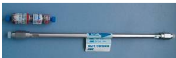
Abb. 29: Größenvergleich der High-Throughput-HPLC-Säule mit einer konventionellen Säule.
